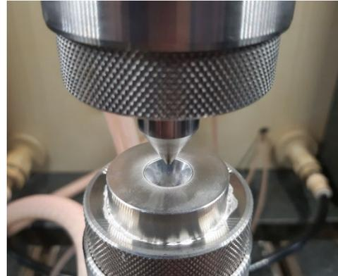
Abb. 1: EC-Präzisionsabtragen eines Werkstücks mit kegelförmiger Kathode
