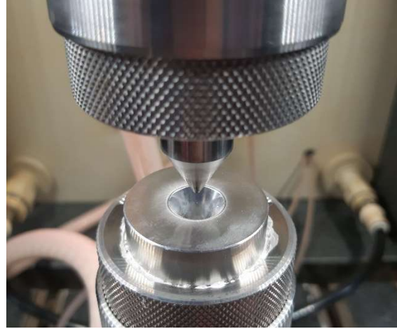
Abb. 1: EC-Präzisionsabtragen eines Werkstücks mit kegelförmiger Kathode
