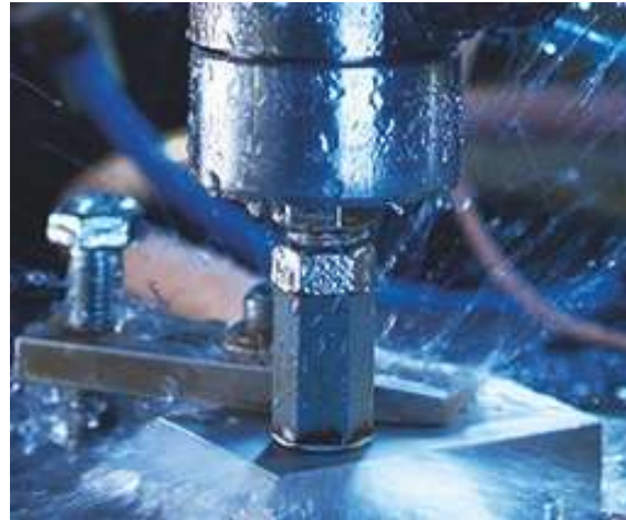
Abb. 1: EC-Präzisionsabtragen eines Werkstücks mit sechseckiger Kathode [Fraunhofer IWU]
